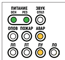
Рис. 56. Индикация при обрыве, коротком замыкании или установке оконечного резистора Рок БР несоответствующего номинала в линии управления
