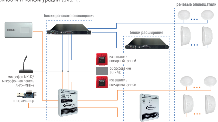
Рис. 1. Пример соединения оборудования в системе АРИЯ
